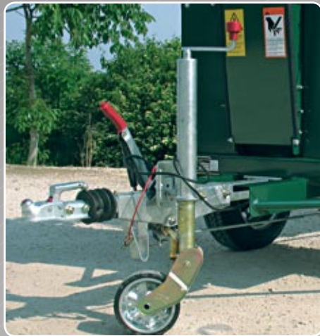
Carrello omologato per traino su strada 80 km/h 80 km/h trailer for road transport Remorque homologuée à 80 km/h pour le transport sur route Carrito para el transporte en carretera con remolque de 80 km/h 80 km/h Fahrwerk für Straßenverkehr Gehomologeerde aanhanger voor wegverkeer tot 80 km/u
