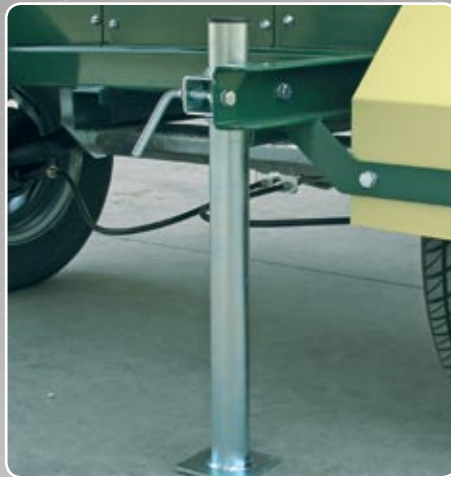
Piedini di appoggio per fase di lavoro Feet for the working session Petit pied d'appui pour la position de travail Pies de apoyo para fase de trabajo Standbein für den Arbeitsabschnitt Steuvoetjes voor de werkstand
